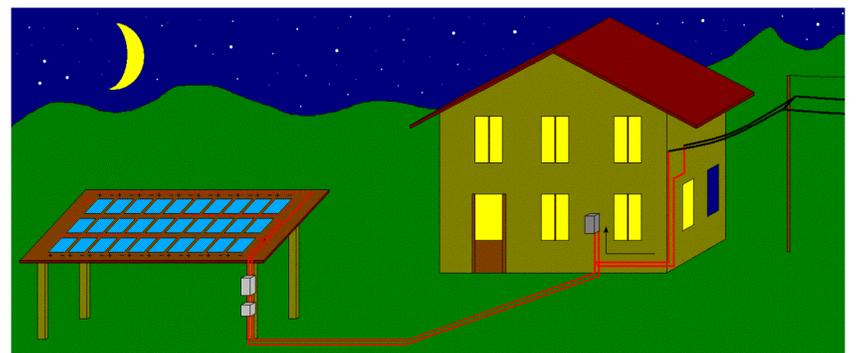
Quando invece si consuma più di quanto l'impianto fotovoltaico possa produrre, l'elettricità necessaria si prende come in qualunque casa dalla rete elettrica.
